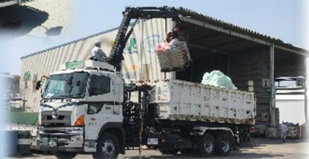
クレーン付 ダンプ車
